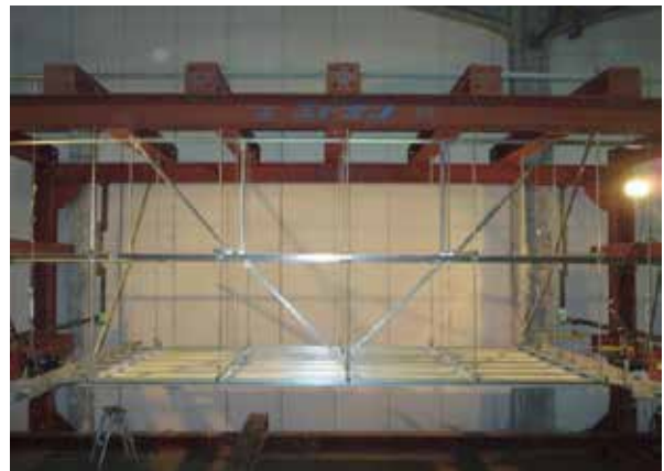
野縁方向ユニット試験
