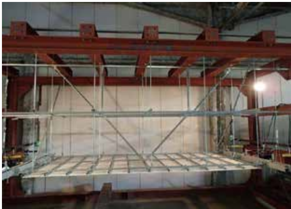
野縁受け方向ユニット試験
