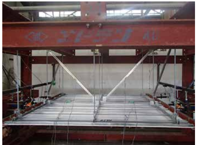
野縁方向ユニット試験
