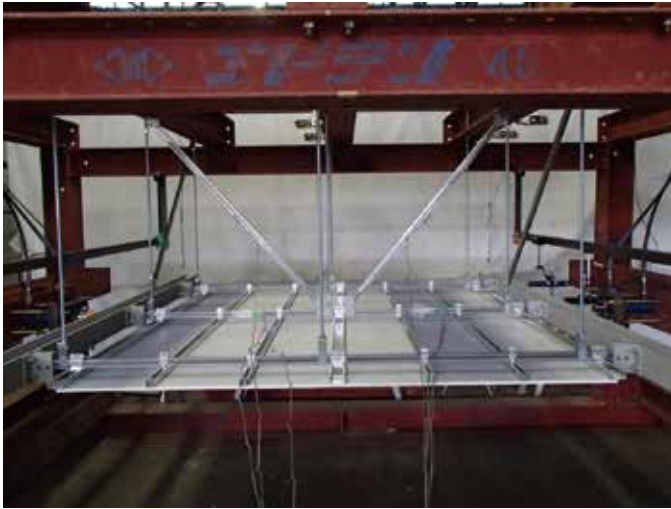
野縁受け方向ユニット試験
